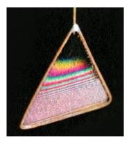
Мыльная плёнка покрыта цветными полосами (результатом интерференции света, отраженного от её стенок).
