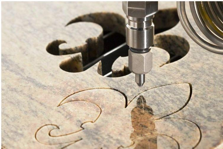
Мало кто знает, что в Москве работает уникальная, быть может, единственная в стране установка. Она режет любые материалы – от твёрдого гранита до пористой синтетической губки – струёй воды. Причём может вести разрез с точностью в доли миллиметра, наперёд заданной компьютером. До последнего времени считалось, что на это способны только лазерные станки. Установка работает в производственном объединении «Прогрессивная технология воды».
