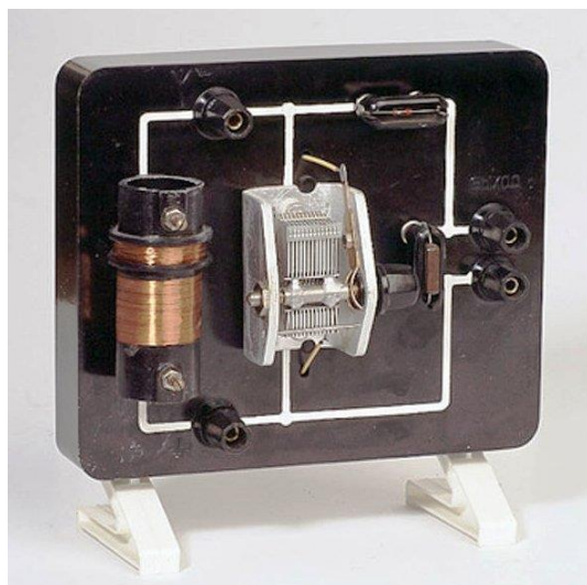
Электрическая схема простейшего детекторного приёмника с конденсатором переменной ёмкости и «круглой» катушкой индуктивности
