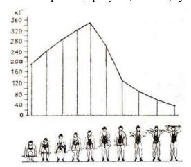
выгодные позы, в которых эффективность усилий наибольшая. В качестве примера рассмотрим максимальную силу, которую может проявить штангист в зависимости от высоты штанги. Из диаграммы видно, что на отрезке, когда сила максимальна (распрямление тела), нужно разогнать штангу так, чтобы дальше она шла по инерции. Это правило применимо не только в спорте, но и везде, где нужно поднимать тяжести.
