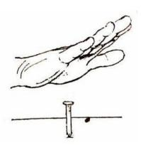
ударе по шляпке с силой 25кг (площадь шляпки 1см², площадь острия 0,1мм²) давление острия гвоздя на доску обратно пропорционально отношению площади острия к площади шляпки: 100мм² / 0,1мм² = P / 25кг, откуда P = 25000кг (25 тонн). Такое огромное давление позволяет забивать гвоздь. Для выполнения этого номера кожа ладони должна быть грубой, ороговевшей (результат долгой тренировки). Обычно при демонстрации номера под ладонь подкладывают носовой платок.
