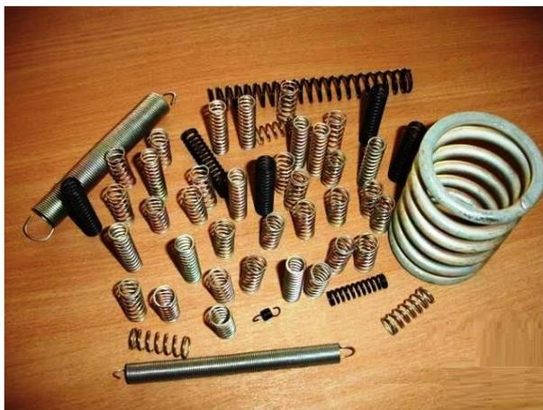
Пружинки бывают разными. Жизнь их не щадит, то и дело приводит в напряжённое состояние. У каждой пружинки свой характер – коэффициент жёсткости. Он показывает величину силы, при которой она деформируется на единицу длины (например, 1 см). Чтобы одолеть «жёсткую» пружинку надо изрядно постараться, а «мягкая» и под собственным весом может видоизмениться.
