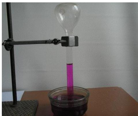
Попробуем и мы создать термоскоп: нагреем стеклянную колбу, перевернём её, опустим в стакан с водой открытым концом. Термоскоп готов. По высоте столбика воды в горлышке колбы можно судить об изменениях температуры: при охлаждении воздуха в колбе столбик воды поднимается вверх, а при нагревании – опускается.
