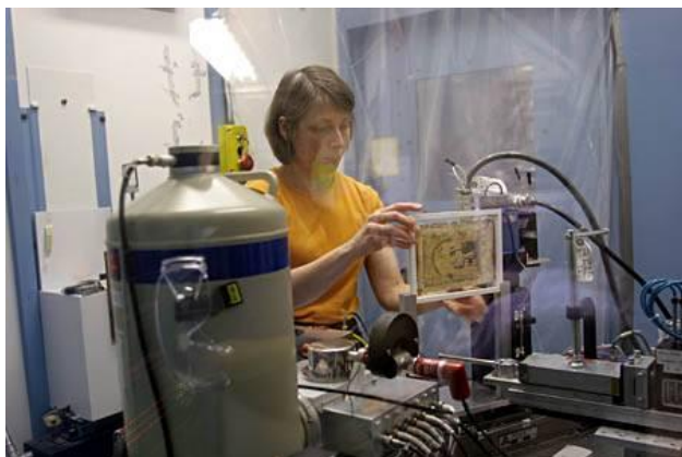
Пергамент был исследован в рентгеновском флуоресцентном анализаторе
