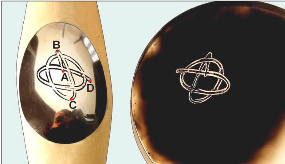
Фотография траектории пятна контакта на основании кельта (слева) и на закопченной опоре.
