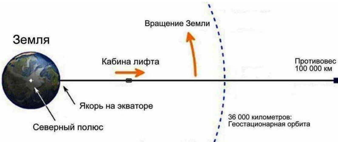
собственным суточным обращением. Под действием гравитационных и центробежных сил трос, соединяющий платформу на геостационарной орбите с Землей, будет постоянно
