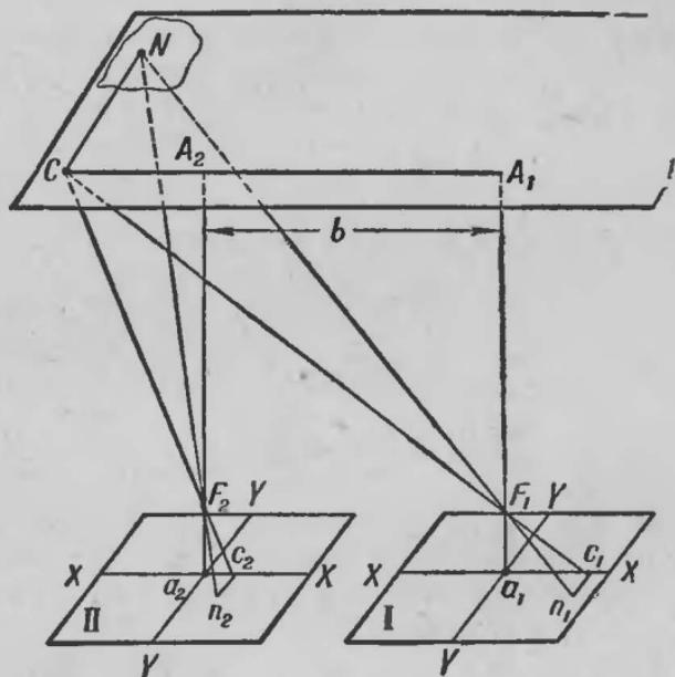
Рис. 77. Схема изображения точки облака на пластинах двух фотоаппаратов, направленных в зенит.
