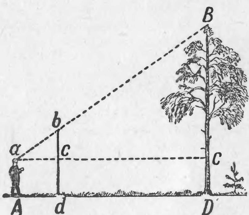
Рис. 8. Измерение высоты дерева при помощи шеста.
