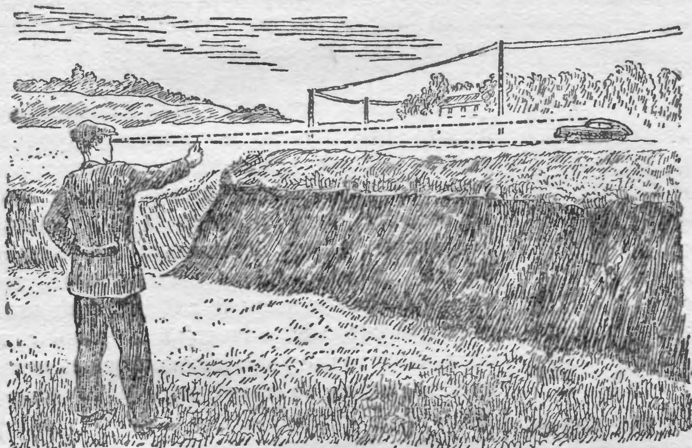
Рис. 38. Употребление спички-дальномера для определения недоступных расстояний.
