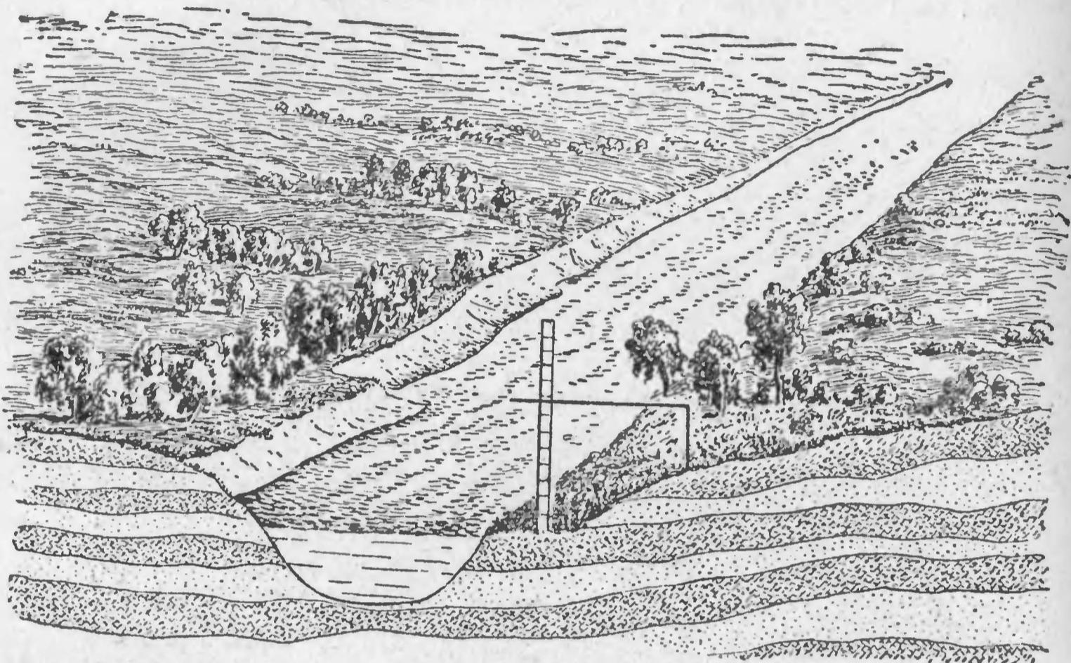
Рис. 44. Измерение профиля берегов.
