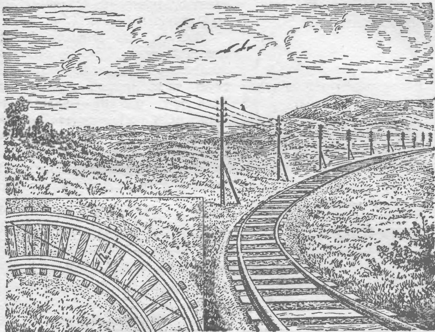
Рис. 85. К вычислению радиуса железнодорожного закругления
