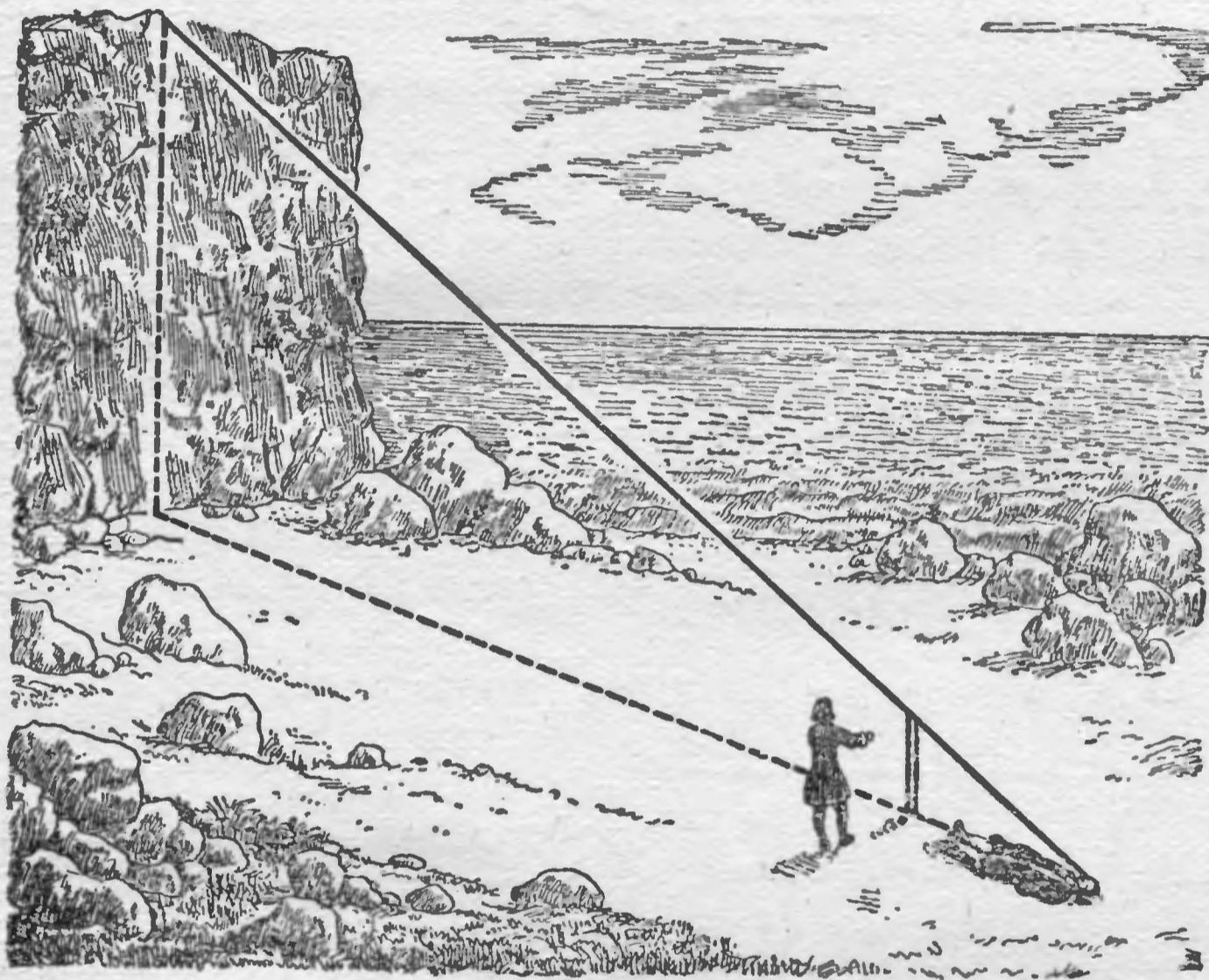
Рис. 7. Как измерили высоту скалы герои Жюля Верна.
