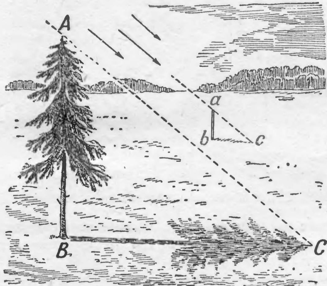
Рис. 1. Измерение высоты дерева по тени.
