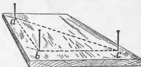
Рис. 4. Булавочный прибор для измерения высот.
