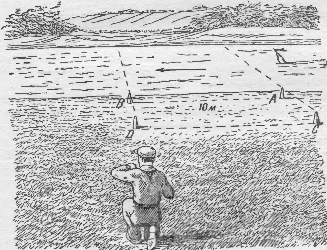
Рис. 41. Измерение скорости течения реки.
