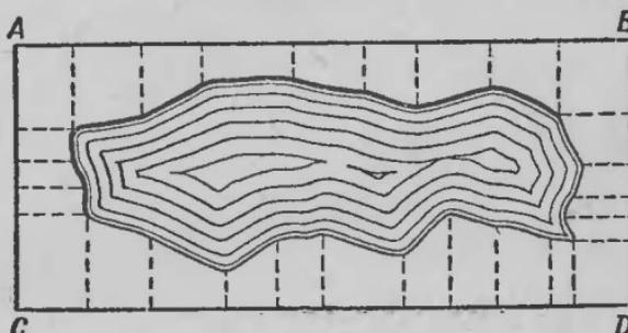
Рис. 68. Съемка озера на план.
