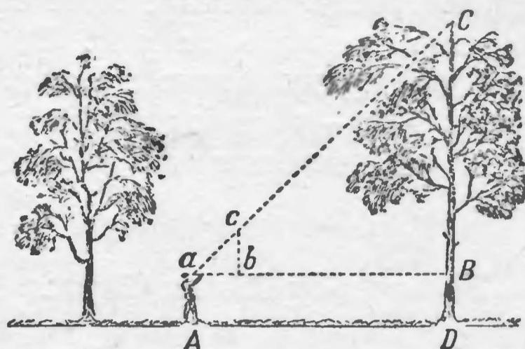
Рис. 5. Схема применения булавочного прибора.
