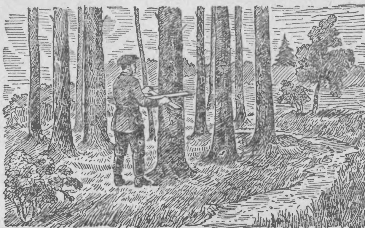
Рис. 19. Измерение диаметра дерева мерной вилкой.
