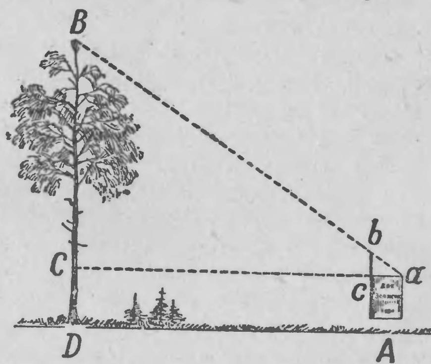
Рис. 9. Измерение высоты при помощи записной книжки.
