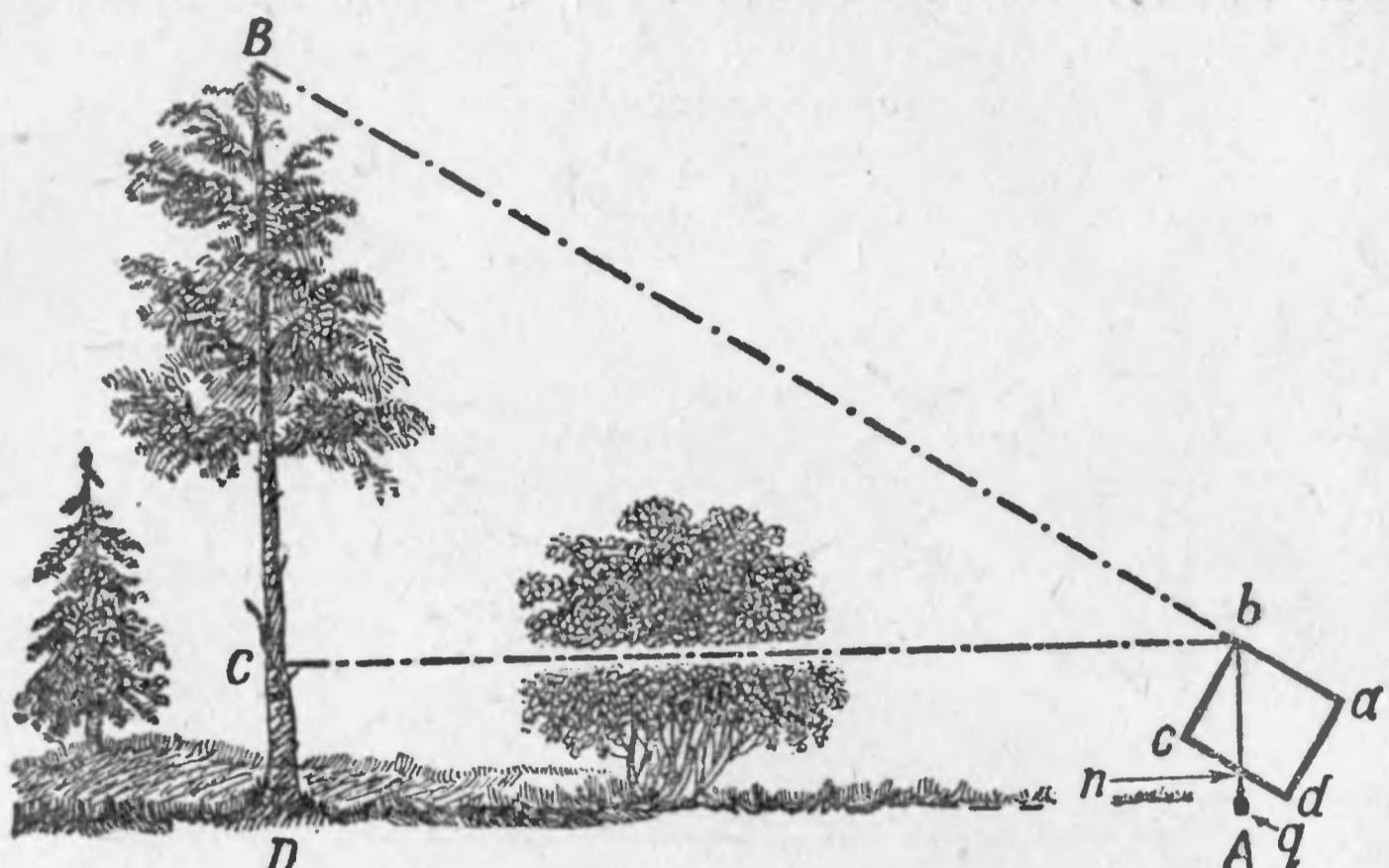
Рис. 11. Схема употребления высотомера лесоводов.
