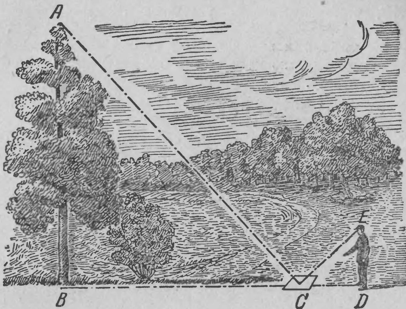
Рис. 14. Измерение высоты при помощи зеркала.
