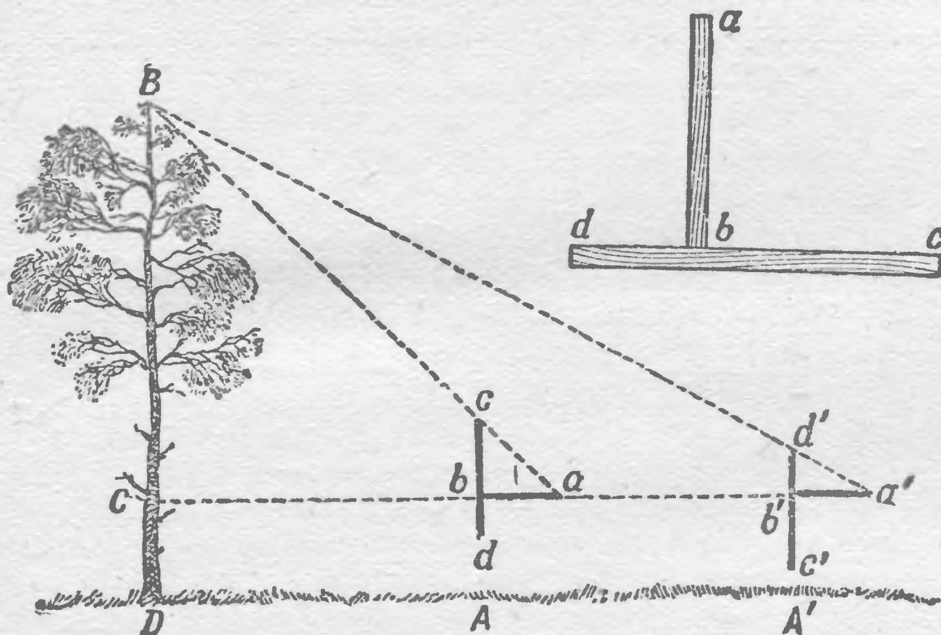
Рис. 10. Применение простейшего высотомера, состоящего из двух планок.
