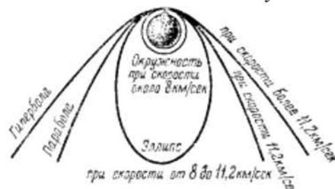
Рис. 26. Судьба пушечного снаряда, выпущенного с начальной скоростью 8 км/сек и более. (Предыдущее рассуждение имело в виду атмосферу, не препятствующую движению снарядов. В реальных условиях наличие сопротивляющейся атмосферы чрезвычайно затруднило бы получение таких высоких скоростей, а быть может, сделало бы их совершенно недостижимыми.)
