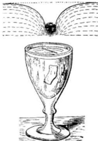
Рис. 61. Игла, плавающая на воде. Вверху – разрез иглы (2 мм толщины) и точная форма углубления на воде (увеличенено в 2 раза). Внизу – способ заставить иглу плавать на воде с помощью лоскутка бумаги.
