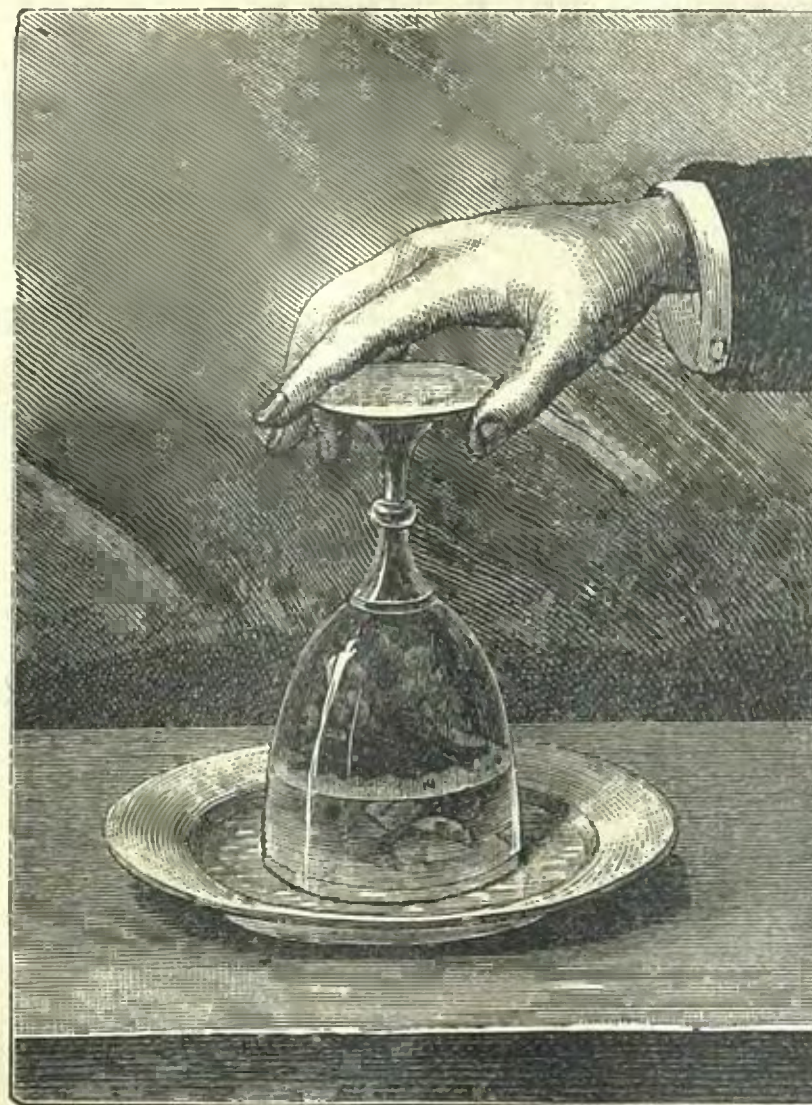
Рис. 17.—Поднятіе воды въ рюмкѣ вслѣдствіе давленія воздуха.
