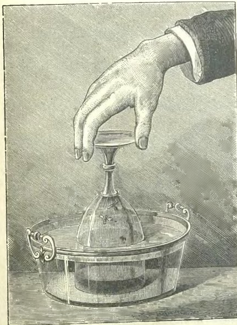
Рис. 21.—Опытъ съ рюжкой, представляющей въ миниатюрѣ явленія, наблюдаемыя въ водолазномъ колоколѣ.
