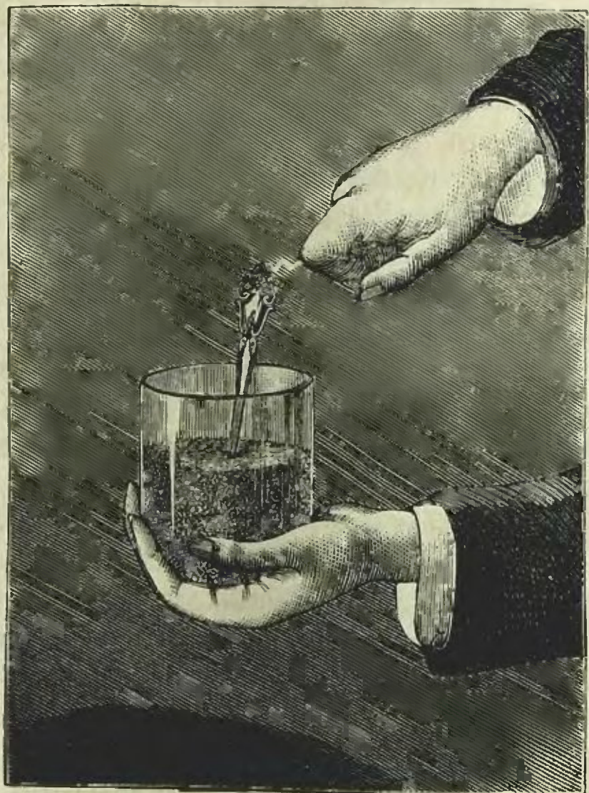
Рис. 74.—Лейденская банка, устроенная изъ стакана, столовой ложки и охотничей дробин.
