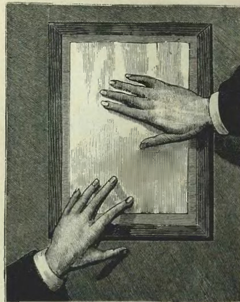
Рис. 208.—Отпечатокъ, полученный посредствомъ тренія на пластинкѣ хромографа.
