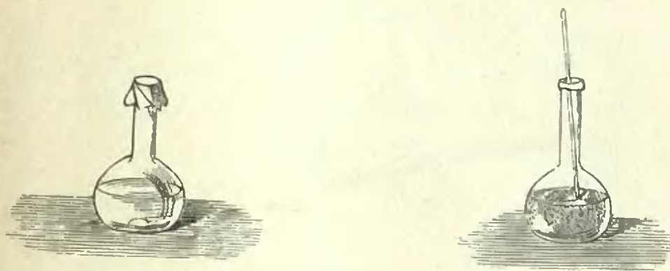
Рис. 161.—Сосудъ, содержащій пересыщенный растворъ сѣрниокислаго натра, кристаллизація котораго показана на правой фигурѣ.
