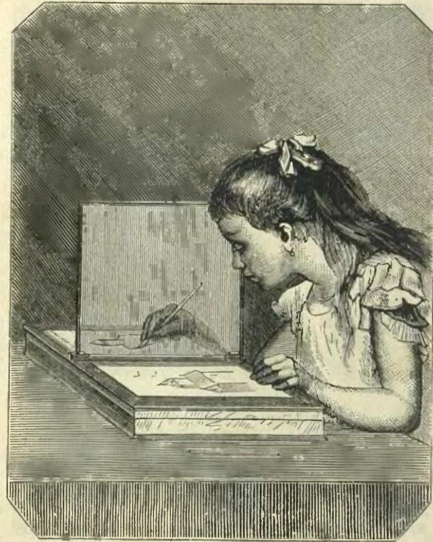
Рис. 115. — Приборъ для рисованія посредствомъ оптическаго изображенія оригинала.
