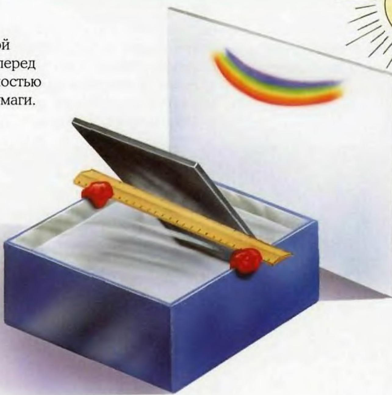
❷ Поставь зеркало в воду наклонно. Угол между зеркалом и поверхностью воды послужит призмой.
