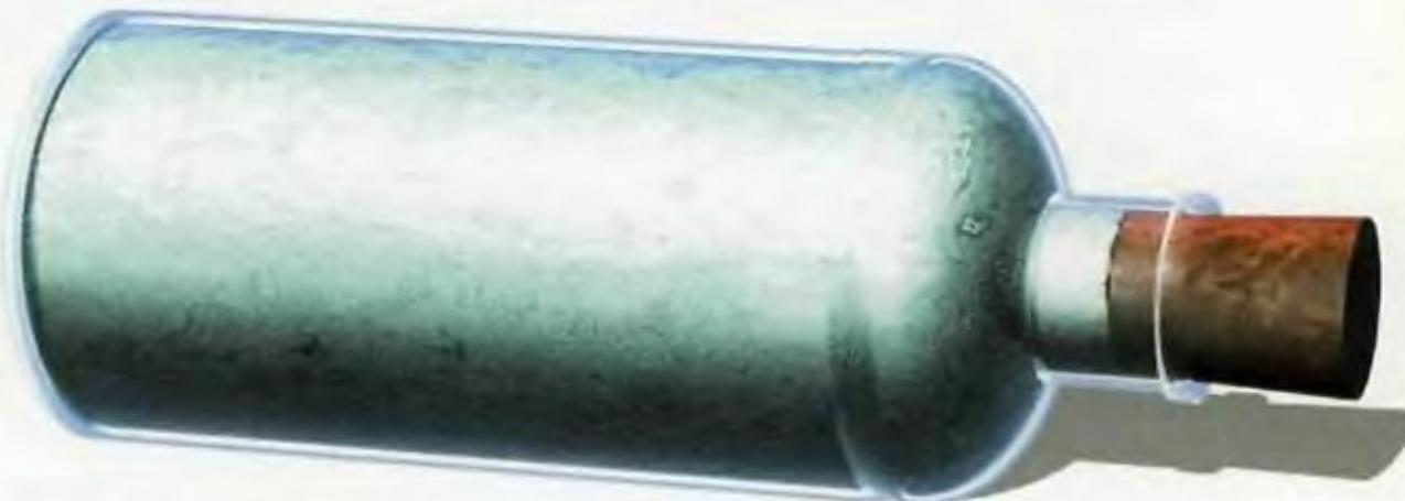
Вода в бутылке замерзла. При замерзании вода расширяется, поэтому пробка выскочила. Пакет нужен для того, чтобы осколки стекла не разлетелись, если вода разорвет бутылку. Если такое случится, попроси кого-нибудь из взрослых помочь тебе выбросить ее.
