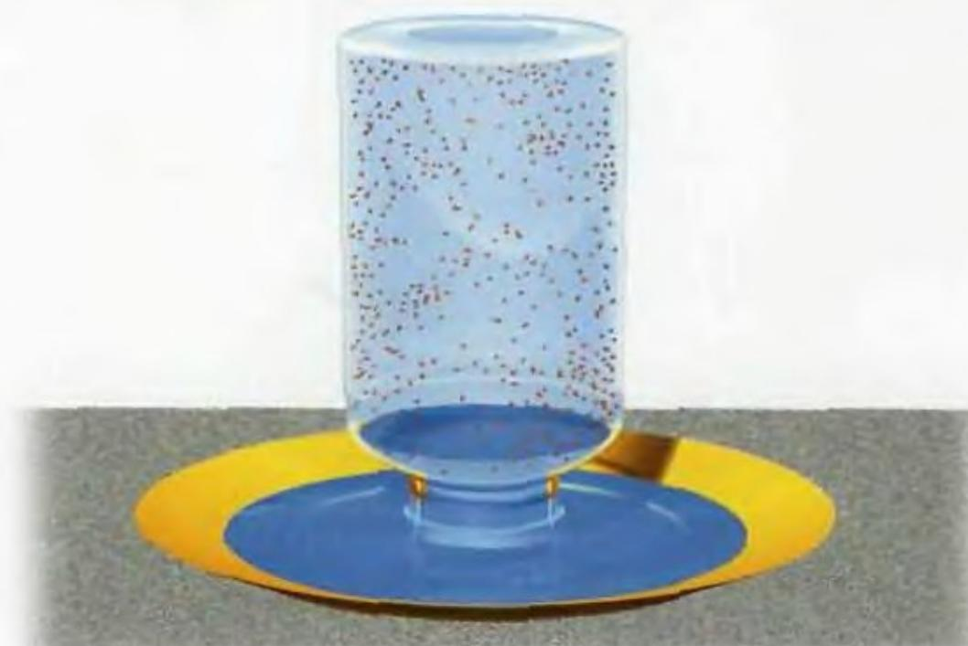
Утром ты увидишь, что опилки заржавели, а уровень воды внутри бутылки поднялся. Это произошло потому, что опилки прореагировали с кислородом воздуха, образовав новое соединение – оксид железа, который и представляет собой ржавчину. Вода заняла то пространство, где был кислород.
