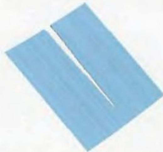
❷ Теперь попробуй порвать лист в другом направлении. Когда пульпу выкладывают на сито, волокна ложатся в одном направлении, что придает бумаге ориентированную структуру. Порвать бумагу поперек волокон труднее, чем вдоль них.
