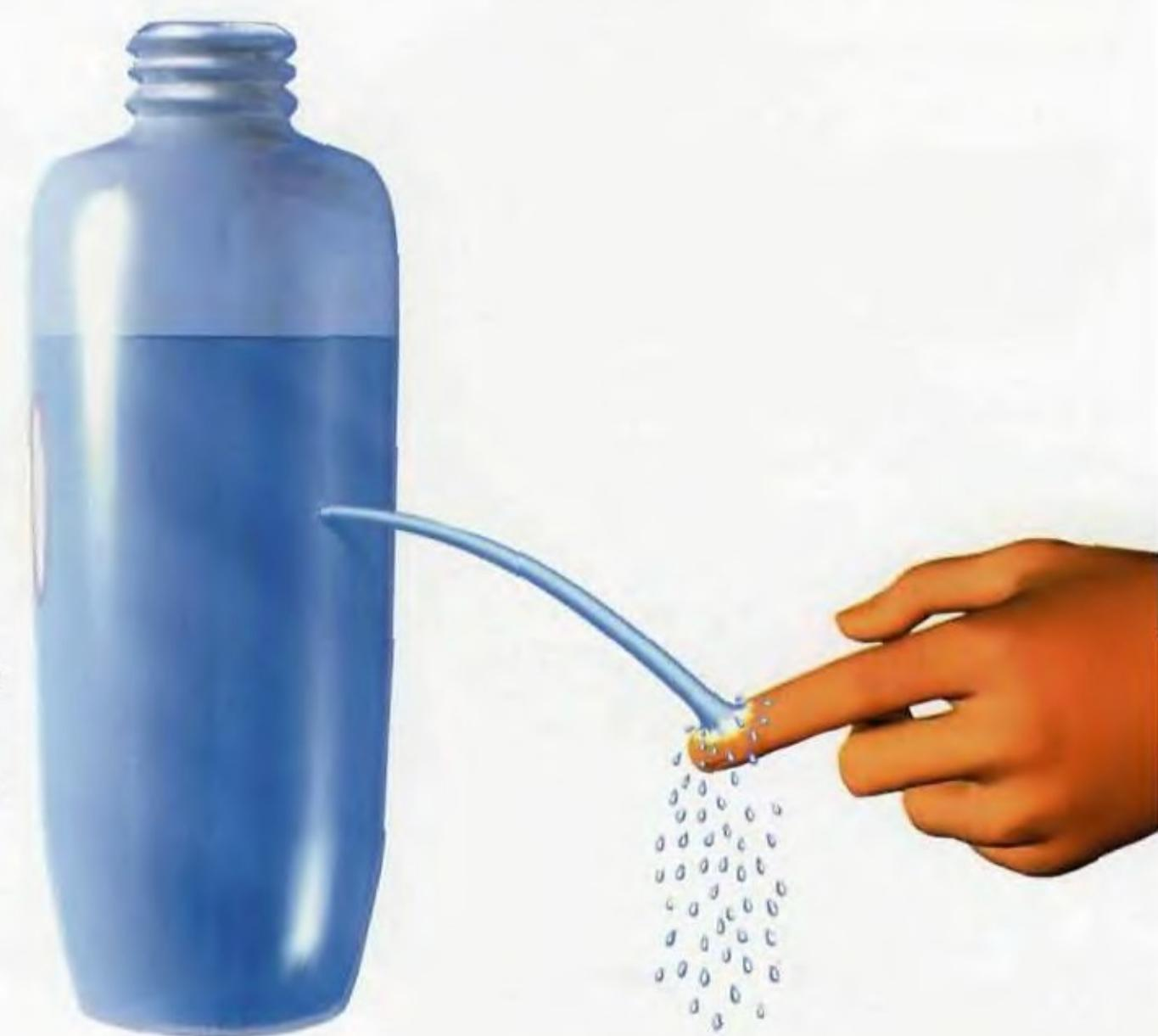
Луч света отражается от стен бутылки и поверхности струи. Именно так распространяется свет по волоконно-оптическим линиям.
