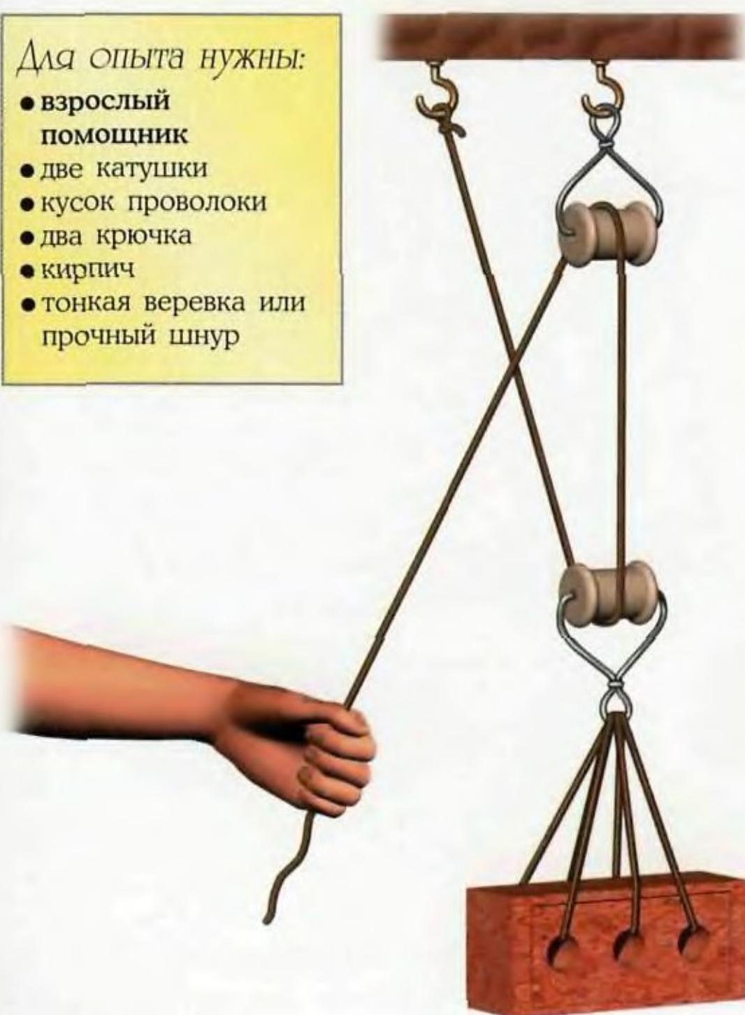
1 Попроси взрослого отрезать два куска проволоки от вешалки, продень их в катушки, загни и закрути концы, как показано на рисунке.
