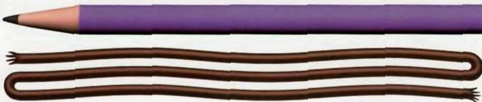
4 Теперь размотай веревку и сравни ее длину с длиной карандаша. Веревка гораздо длиннее. Это расстояние прошли бы точки на поверхности винта такой же длины. Небольшая сила, приложенная на большом расстоянии, производит такую же работу, что и большая сила, приложенная на меньшем расстоянии.
