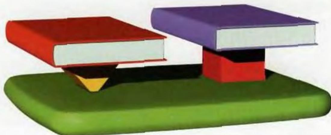
2 Посмотри на следы на пластилине. Треугольная деталь – это клин. Направленное вниз давление оставляет на поверхности пластилина более глубокую отметину. Так действует топор – направленная вниз сила расталкивает древесину в разные стороны.
