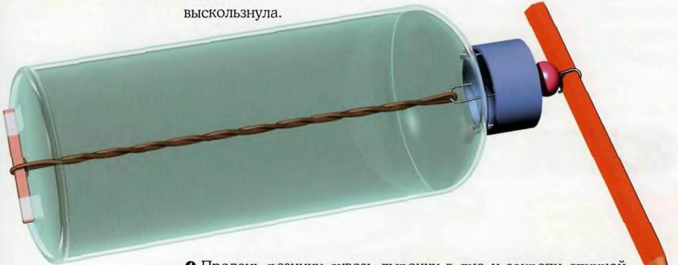
❹ Продень резинку сквозь дырочку в дне и закреши спичкой. Приклей спичку клейкой лентой. Цепочкой из скрепок «вылови» конец резинки из бутылки и зацепи его за продетую сквозь пробку скрепку.
