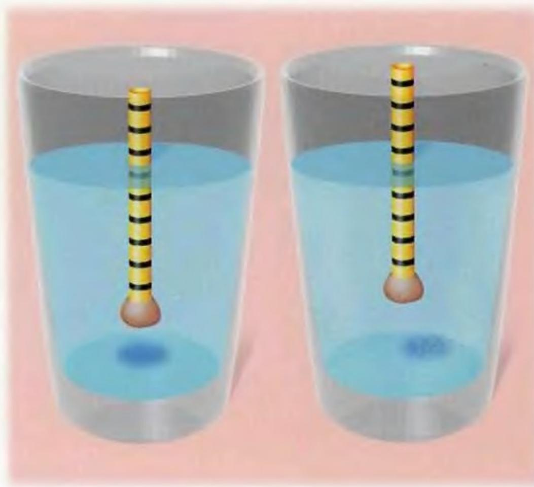
Прибор для измерения плотности жидкостей называется ареометром. Измерь плотность других жидкостей, например молока, сока, растительного масла.
