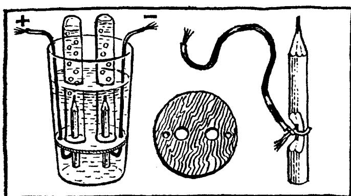
В следующем опыте толстостенный чайный стакан, расширяющийся кверху, будет служить электролитической ванной. Приготовьте фанерный кружок такого диаметра, чтобы он прижался к стенке стакана в трех-четырех сантиметрах выше дна. В кружке заранее просверлите два отверстия (или вырежьте в нем по диаметру прорезь), неподалеку шилом проколите два отверстия: через них будут
