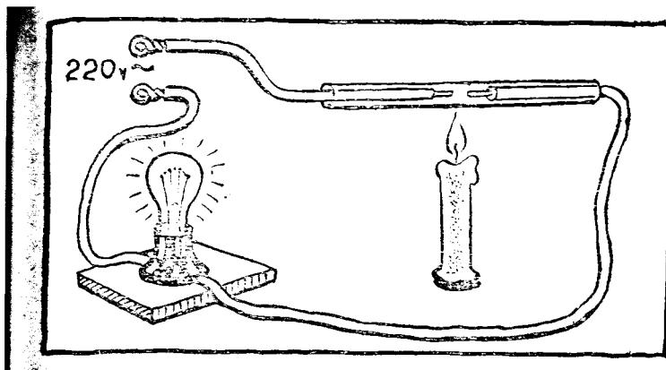
Для этого опыта удобнее взять настольную лампу. Один из ее проводов отсоедините от вилки и удлините, не забывая о хорошей изоляции.
