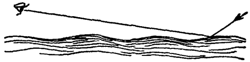
Рис. 28. Объяснение смещения отражения: отраженный луч проходит ближе к поверхности воды, чем падающий.
