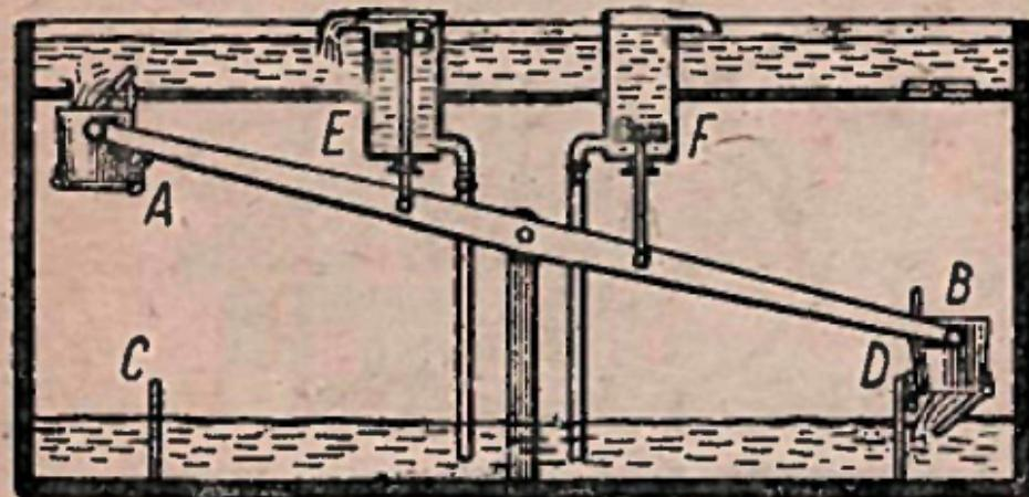
Вода, выливающаяся из ведер, возвращается в верхний бассейн насосами *E* и *F*, которые приводятся в действие качанием коромысла. По мнению изобретателя, такая установка должна работать безостановочно и может служить неисчерпаемым источником энергии.
