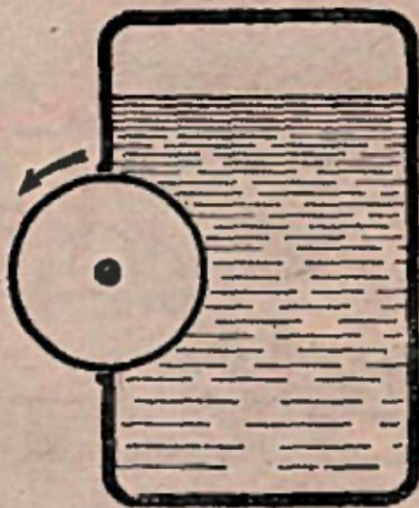
Изобретатель полагает, что так как наружная половина колеса при всех его положениях будет тяжелее, чем погруженная, то колесо должно находиться в непрерывном вращении и может служить неисчерпаемым источником энергий.
