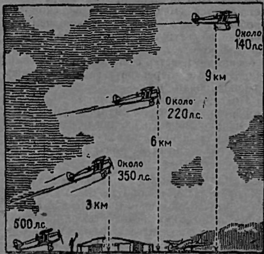
По мере подъема мощность авиационного мотора уменьшается. Например, мотор, который на земле развивает мощность в 500 л. с., на высоте 6 км. уменьшает мощность до 220. Почему?
