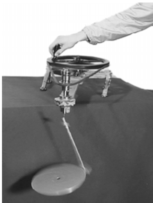
Рис. 3.9. Вращение диска на центробежной машине.
