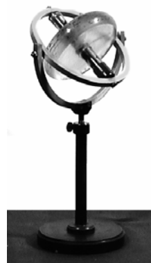
Рис. 3.18. Гироскоп в кардановом подвесе.
