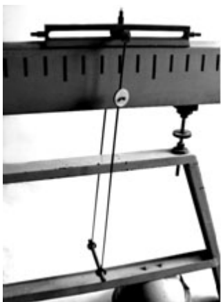
Рис. 2.32. Тележка с маятником на скамье с воздушной подушкой.
