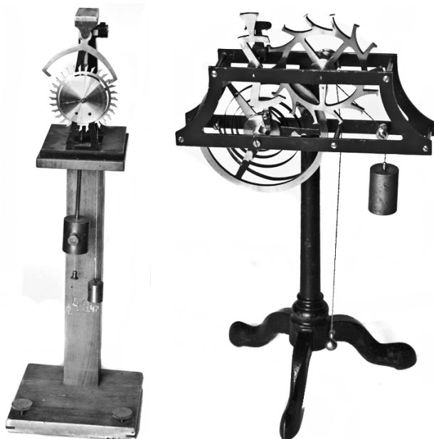
Рис. 6.38. Часовые механизмы – маятниковый (слева) и балансирный (справа).
