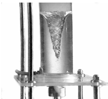
Рис. 9.27. «Смерч», возбуждаемый магнитной мешалкой.
