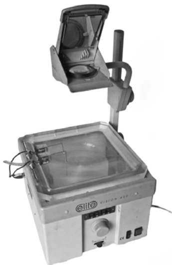
Рис. 10.14. Установка для наблюдения капиллярных волн на базе кодоскопа.
