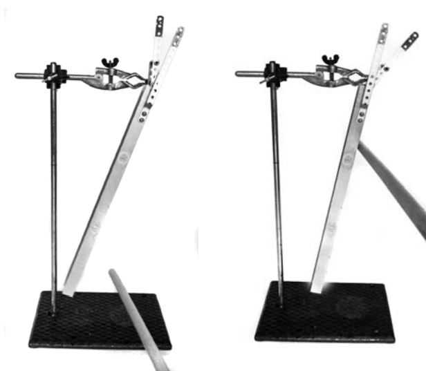
Рис. 4.11. Реакция оси при ударе по маятнику.
