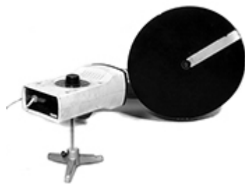
Рис. 1.26. Вращение диска с меткой в стробоскопическом освещении.
