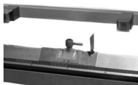
Рис. 5.30. Реактивная тележка на воздушной дорожке.
