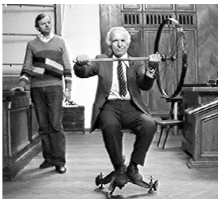
Рис. 4.5. Скамья Жуковского – опыт с велосипедным колесом.
