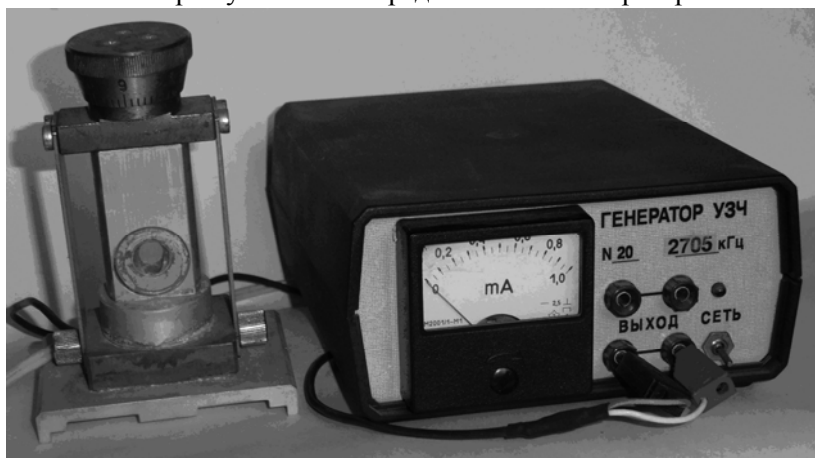
Рис. 11.34. Акустооптический модуль и генератор ультразвуковой частоты фирмы «Владис».
