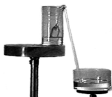
Рис. 9.14. Сифон, не требующий засасывания.
