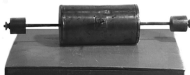
Рис. 8.21. Демонстрация зависимости метацентрической высоты от положения центра масс плавающего тела.
