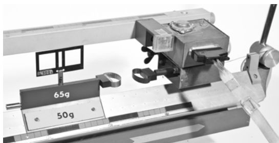
Рис. 2.20. Датчик силы на воздушной дорожке.
