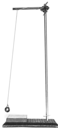
Рис. 6.8. Ферромагнитный маятник над магнитом.
