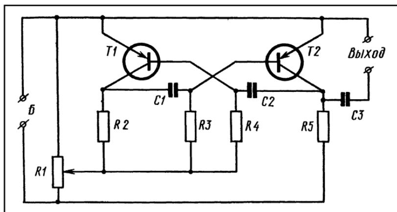
Рис. 26. Схема звукового генератора:
