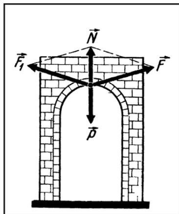
Рис. 6. Силы, действующие на арочное перекрытие.
