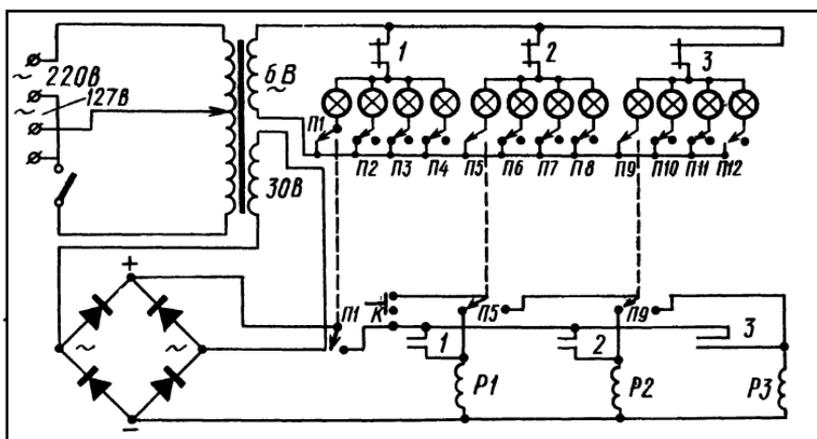
Рис. 33. Схема играющего автомата.
