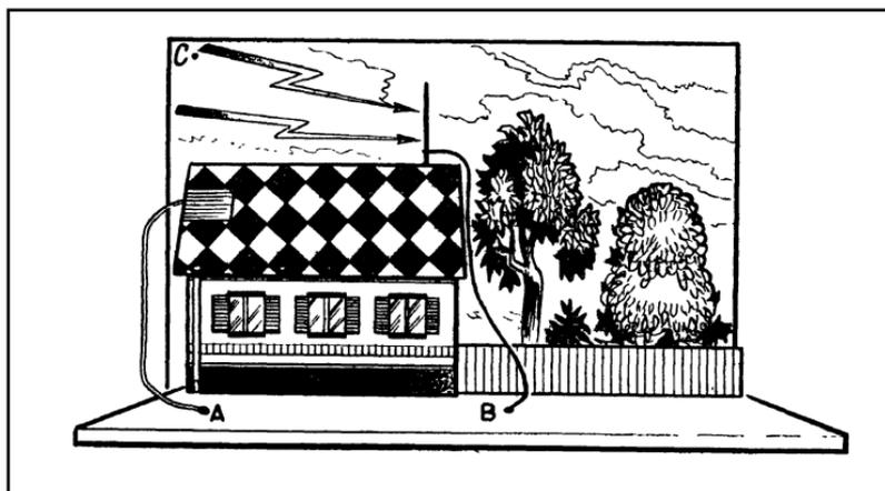
Рис. 16. Декорация для демонстрации действия молниеотвода.
