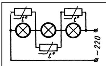
Рис. 14. Схема опыта с термисторами.
