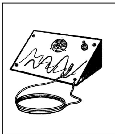
Рис. 24. Общий вид тремометра.
