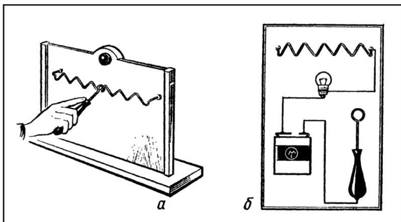
Рис. 23. Внешний вид и схема игры «Проведи и не задень!».
