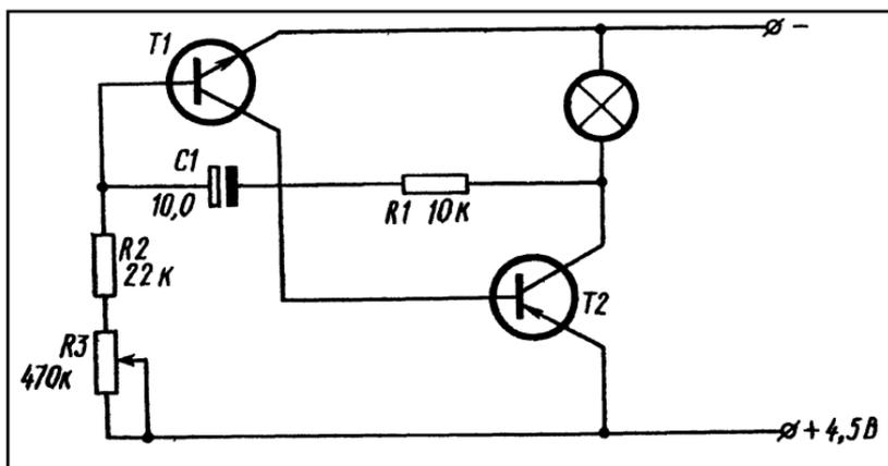
Рис. 65. Схема мигающего маяка.
