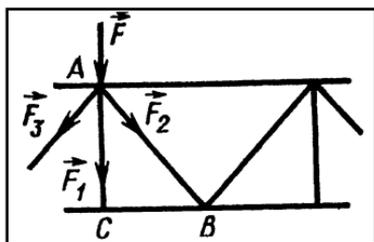
Рис. 3. Нагрузка, действующая на ферму.
