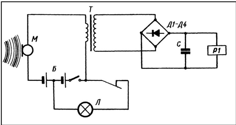
Рис. 31. Схема установки «Задуй свечу!».
