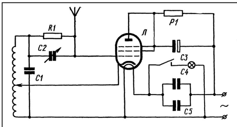
Рис. 28. Схема установки «Попробуй, отними!»
