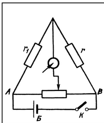
Рис. 44. Схема болометра:
