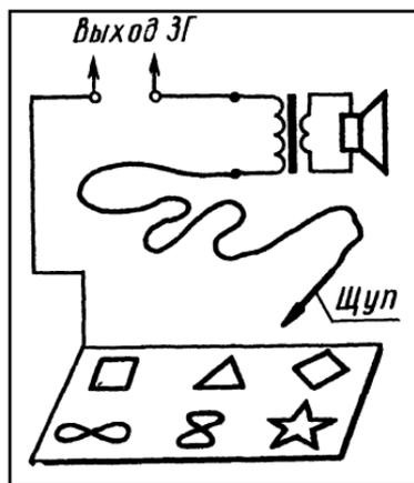
Рис. 25. Схема тремометра.
