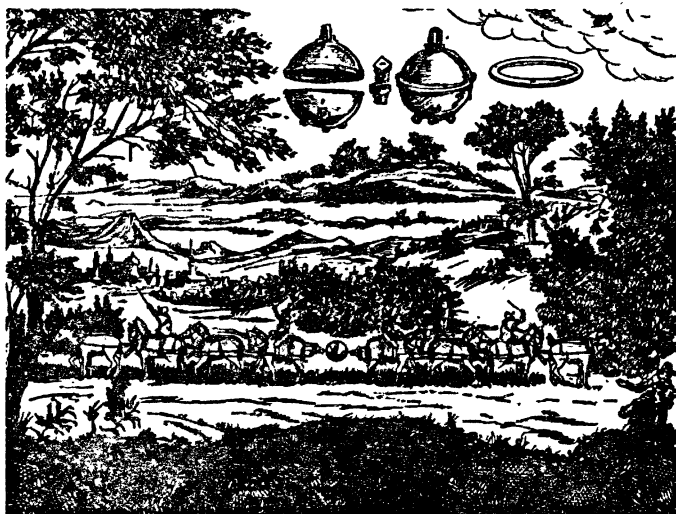
Рис. 76. Опыт Герике с медными полушариями
