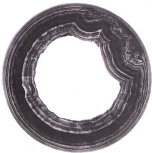
На стенках водопроводной трубы диаметром 15 сантиметров за пять лет осел слой твердого углекислого кальция. Горячий источник Шпрудель. Карловы Вары. (ЧССР).
