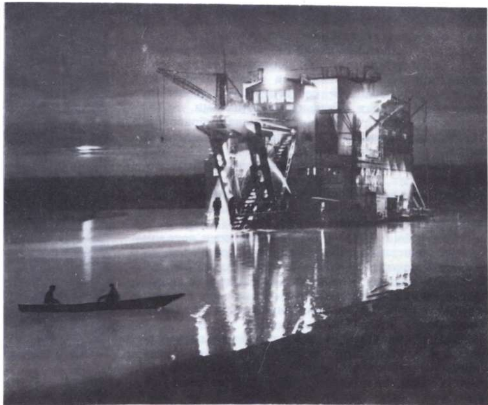
Плавучая фабрика-драга, добывающая алмазы в таежной реке. Якутия.
