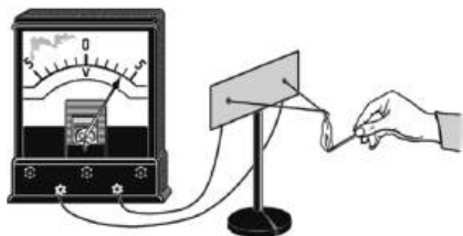
Рис. 38. Демонстрация генерации термо ЭДС
