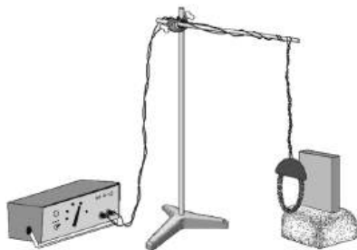
Рис. 77. Демонстрация разворота катушки в поле постоянного магнита
