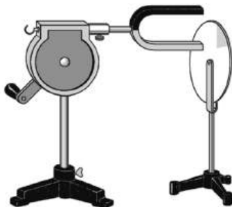
Рис. 108. Раскрутка диска вращаемым магнитом
