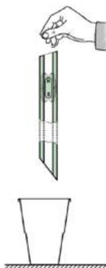
Рис. 112. Падение магнита в трубе
