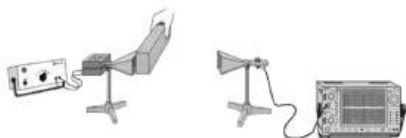
Рис. 147. Демонстрация интерференции СВЧ радиоволн
