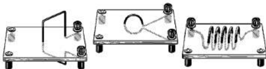
Рис. 71. Панели для визуализации магнитных полей
