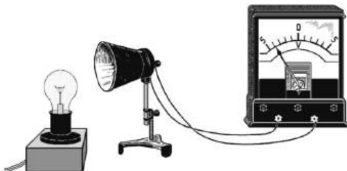
Рис. 39. Демонстрация работы термостолбика
