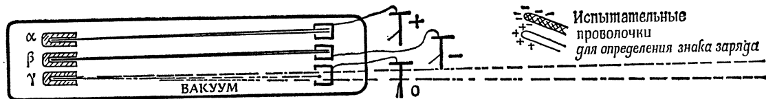
Фиг. 41. \alpha - и \beta -лучи несут заряд, \gamma -лучи заряда не несут.
