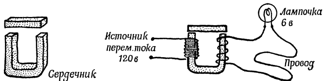
Фиг. 78. Опыт 4. Самодельный трансформатор.
