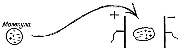
Фиг. 86. Поляризация молекулы.
