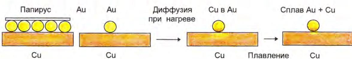
ревали. Во время нагрева успевала произойти незначительная диффузия золота в медь и наоборот. В результате этого в очень узкой зоне контакта шарика и пластины образовывался **медно - золотой сплав**, температура плавления которого ( в этом и заключался секрет !!! ) была гораздо ниже температуры плавления чистого золота и чистой меди и равнялась 910° С. Именно этот ультратонкий эффект каким-то чудом и удалось подметить этрусским мастерам.
